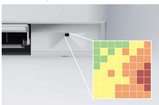
Der intelligente Wärmesensor misst die Temperatur von Oberflächen eines Raumes; dazu wird dieser in ein Raster mit 64 verschiedenen Quadranten unterteilt.
