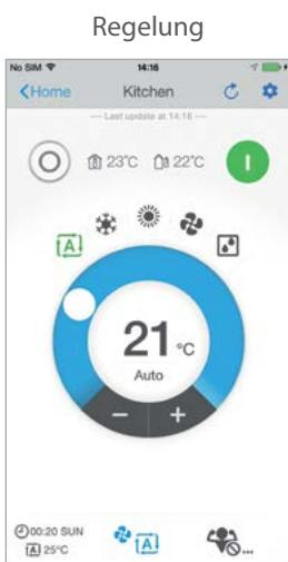
Regelung von Betriebsart, Temperatur, Luftreinigung, Ventilatordrehzahl und Luftrichtung
