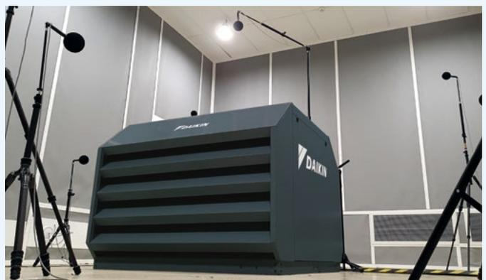
Messung der Schallleistungspegel in einer Akustikkammer
