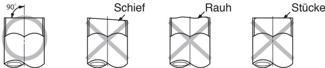
3 Kein Gas durch zu sickern, alle Stahl-stücke von der Abschnittkante der Leitung mit einem Abschnitt-werkzeug entfernen.
