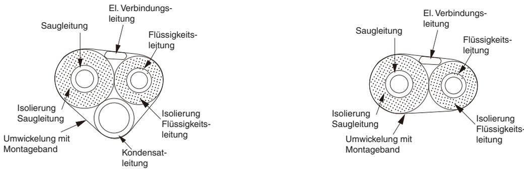
Bild 29: Rohrführung im Querschnitt
