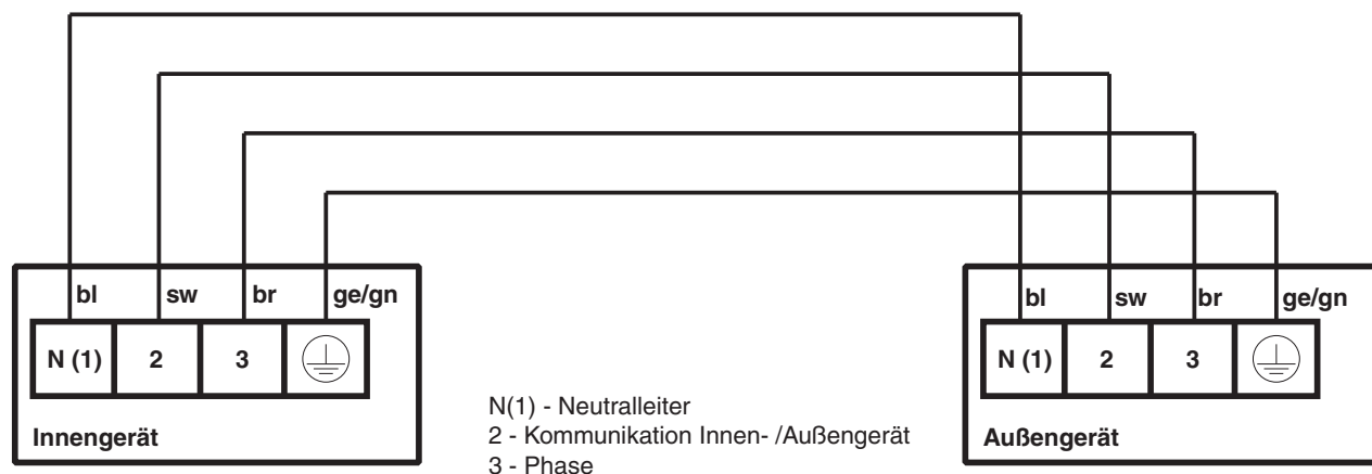
Bild 24: Elektrische Verbindung Innengerät – Außengerät (Baugröße 9 - 12)
