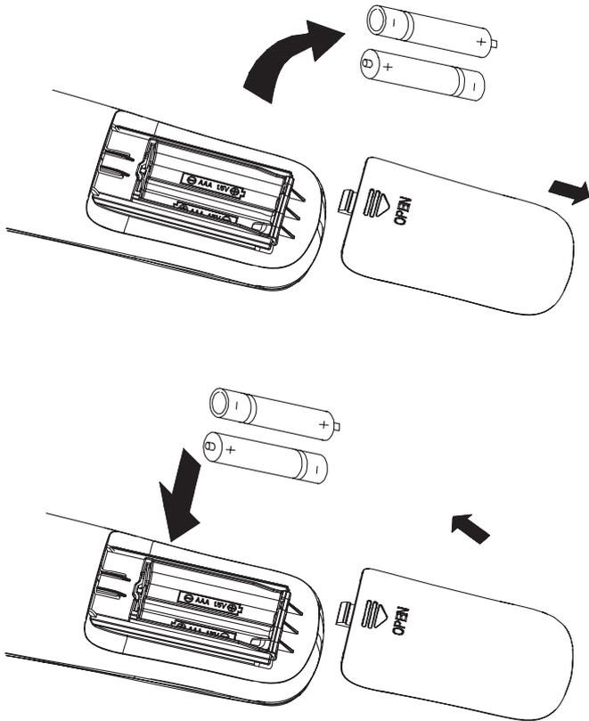
Bild 9: Batteriewechsel
