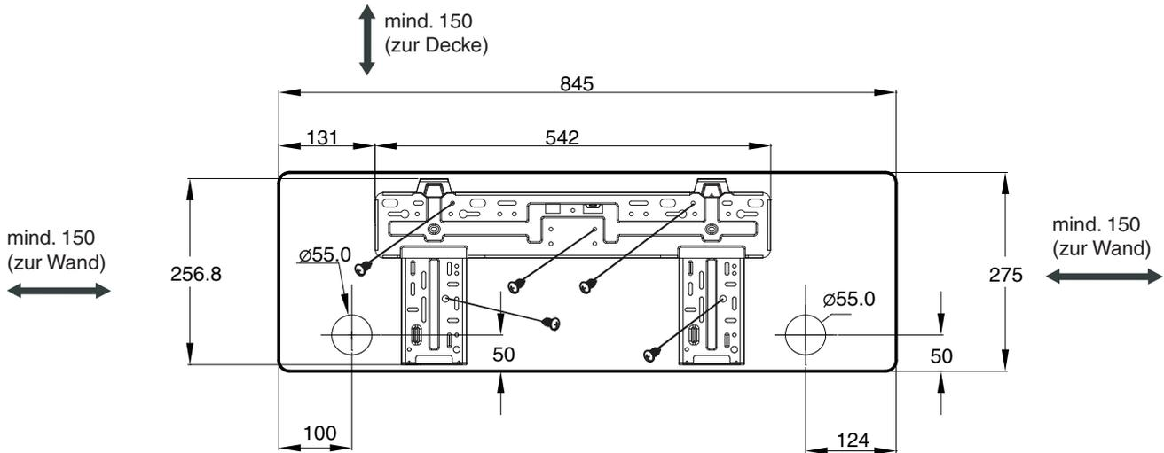
Bild 14: Montageplatte für Baugröße 09, 12
