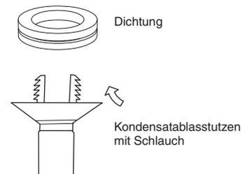
Bild 27: Anschluss Kondensatableitung im Außengerät
