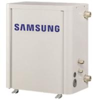
Wärmetauscher-Einheit mit einem Hochleistungs-Plattenwärmetauscher | dezentrale WW-/ bzw. KW- Erzeugung mit Vorlauftemperaturen von +7 bis +50°C | Gehäuse aus verzinktem Stahlblech pulverbeschichtet | elektronisches Expansionsventil mit 2000 Regelschritten | Optional mit Kabel-Fernbedienung mit Echtzeit-, Tages- und Wochentimer sowie Raumtemperaturfühler | Regelung nach Außentemperatur möglich | optional CnT-Kontakt und externe ON/OFF-Steuerung möglich | für Innenaufstellung
